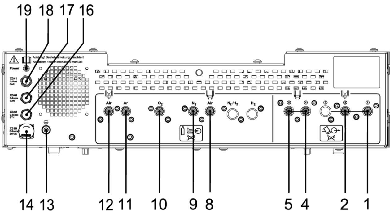
**Abb. 25: rückseitige Anschlüsse der Q-Gas O<sub>2</sub> 4500**
