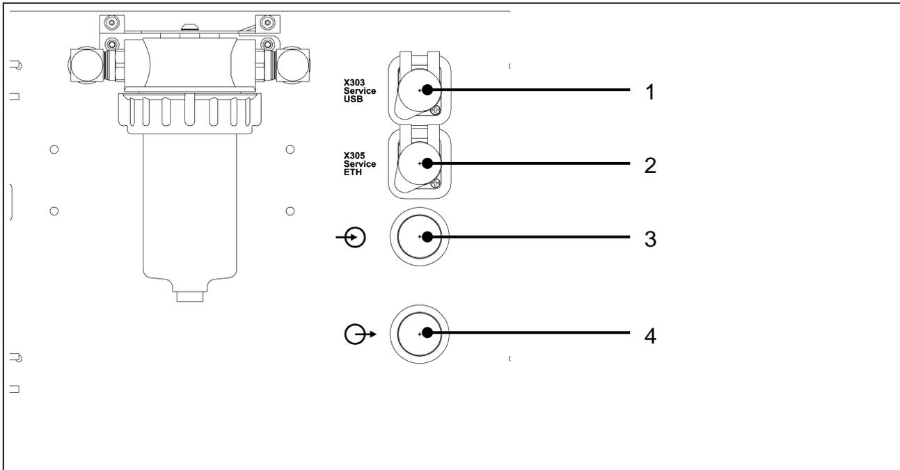
**Abb. 13: B - Anschlüsse hinter der Klappe**
