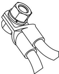
**Abb. 19: Kabelschuhe der Kathodenleitungen (Anschluss 16) gegebenenfalls gegeneinander setzen**
