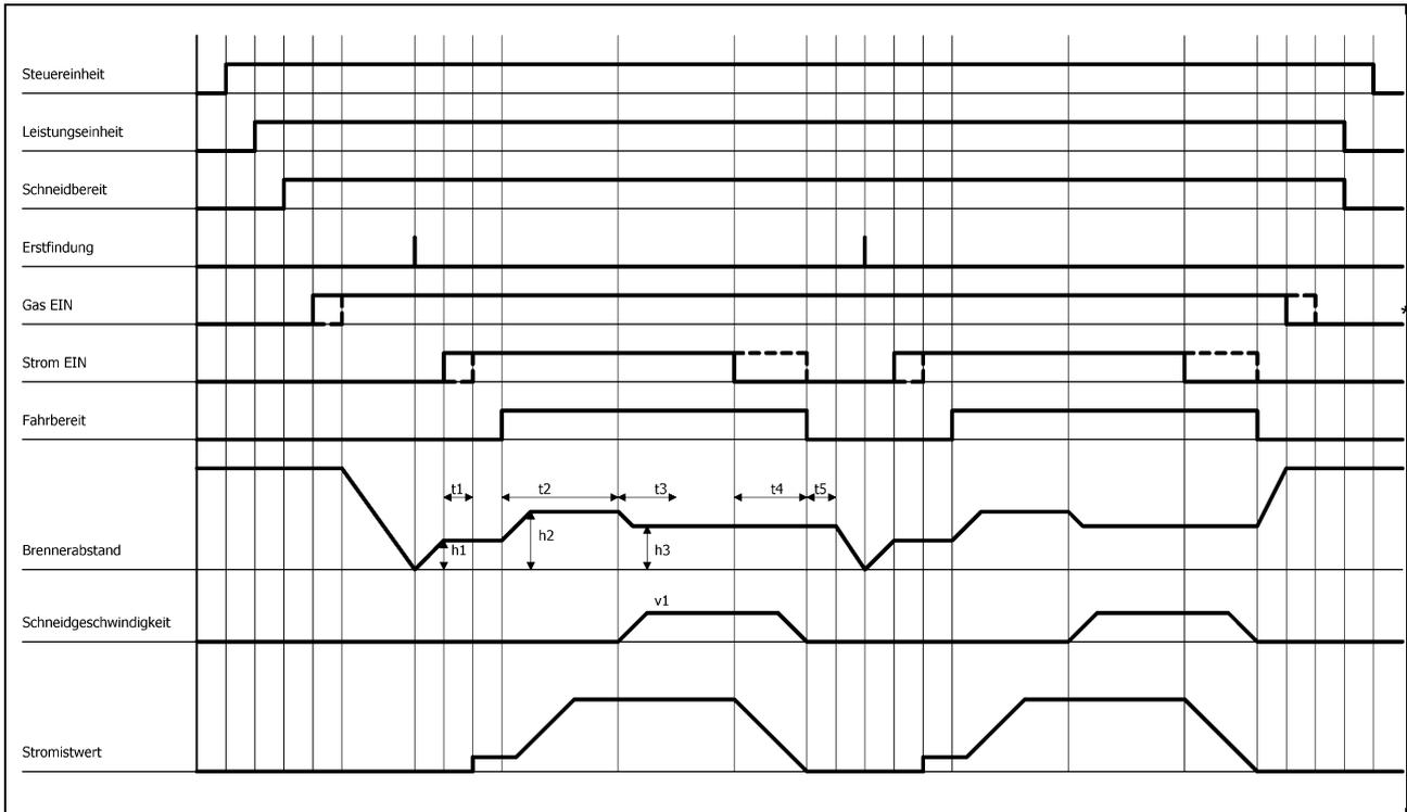
**Abb. 20: schematische Darstellung eines Schneidvorgangs mit Abstandsregelung (Abstandsregelungssystem)**
