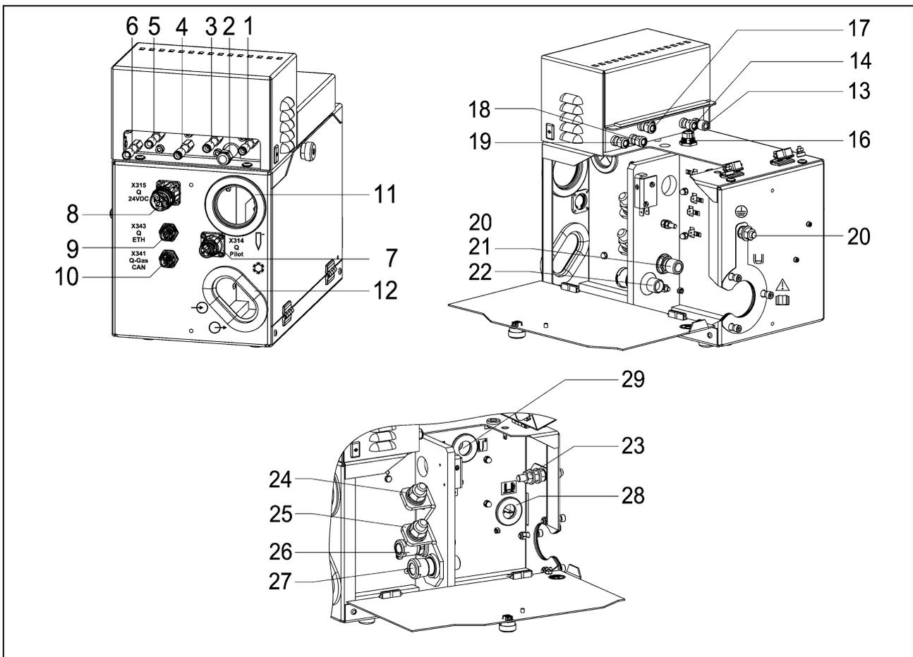
**Abb. 38: Anschlüsse des Q-Port**
