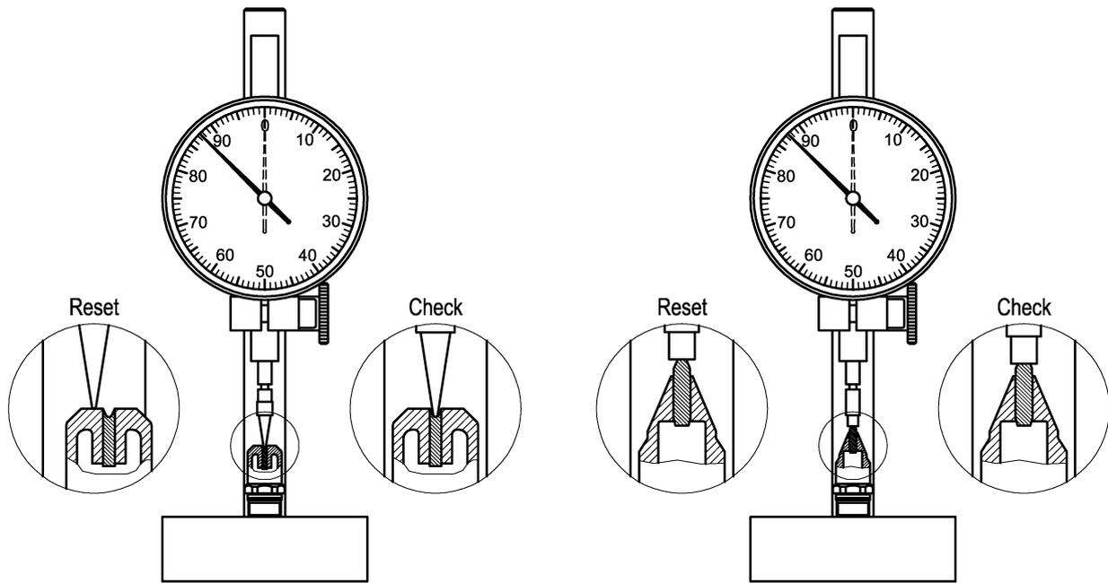
Prüfung mit spitzem Messuhrtaster
