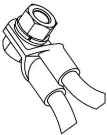
Abb. 19: Kabelschuhe der Kathodenleitungen (Anschluss 16) gegebenenfalls gegeneinander setzen
